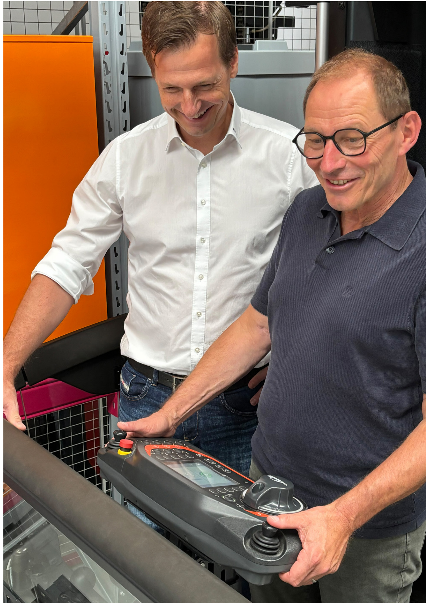
Im Bild: Das aktuelle Bedienpult MU-M (steht für ManUp-Modular). Deutliche Verbesserungen aus Kundensicht im Vergleich zum Vorgängermodell gibt es bei Bedientoleranz, Ergonomie, Joystick und Display.
