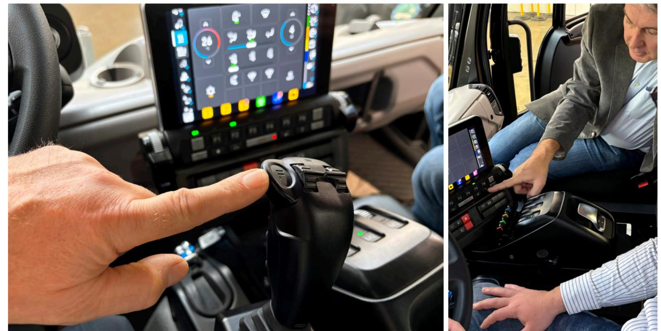
Das UNI-TOUCH-System auf einen Blick: Die Mittelkonsole besteht aus einem Touchscreen mit zusätzlich analogen Tasten, diversen Kippschaltern und dem RAFI LINEAR JOYSCAPE.
