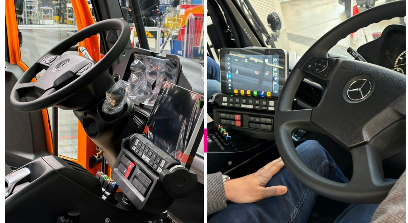
Maximale Fahrfreiheit: Als Standard auf der linken Fahrerseite eingebaut, kann das Lenkrad über eine Schiebevorrichtung nach rechts verschoben werden.
