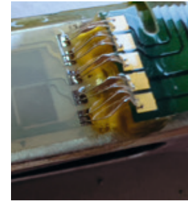
Abbildung 5: Drahtbonden als Verbindungstechnik für die Serienfertigung
