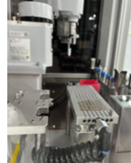
Abbildung 4: automatisiertes Aufbringen mit Vakuumpipette
