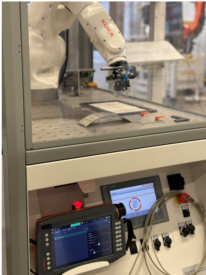
机器人与操控设备的共生: KUKA smartPAD pro拥有众多出众特性, 可发光的急停按钮只是其中之一。
